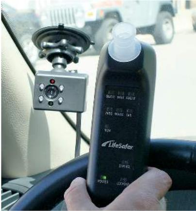
El FC100 de LifeSafer con detector manual y sistema de cámara está controlado por la cámara. La cámara debe detectar su imagen y “ver” el objetivo en la parte posterior del detector manual antes de que le permita tomar una prueba. Sostenga el detector manual de 4 a 8 pulgadas (10.2 cm a 20.3 cm) del frente del módulo de la cámara para permitir que esta libere el dispositivo manual para realizar la prueba.
